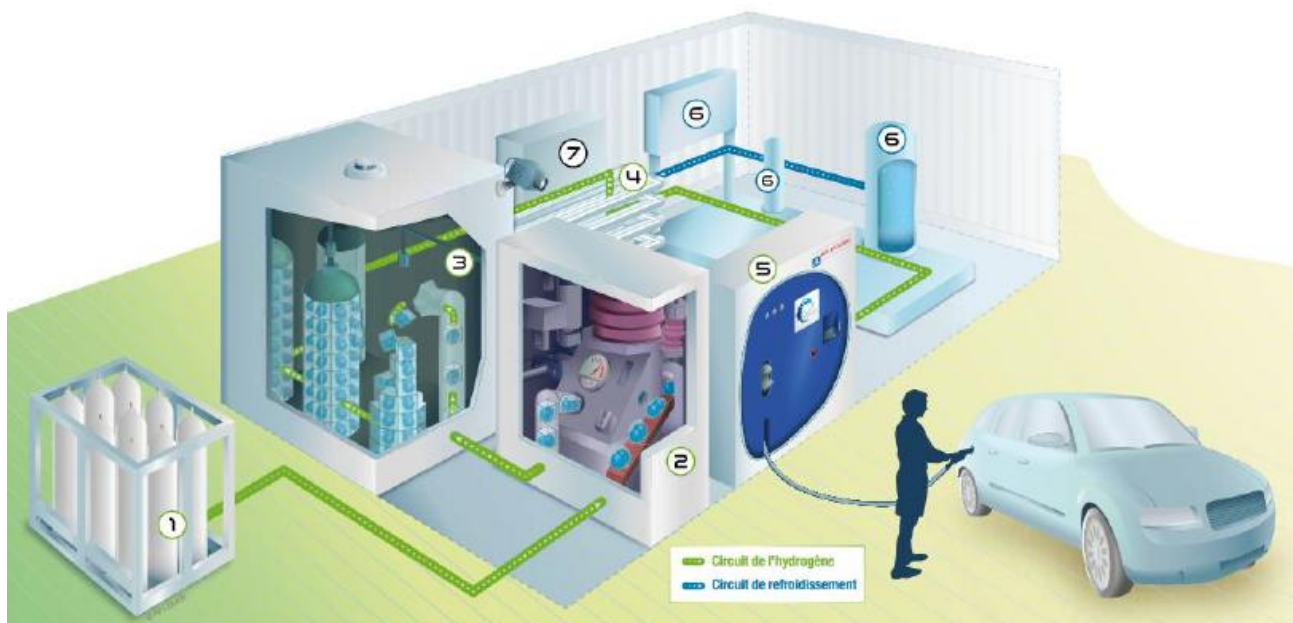
Figure 7 : Fonctionnement d'une station-service à hydrogène
